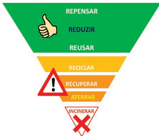
Figura 4 - Hierarquia para gestão de resíduos sólidos da Aliança Internacional de Resíduo Zero (ZWIA)
